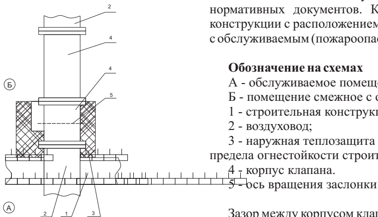
Схема установки в перекрытиях
