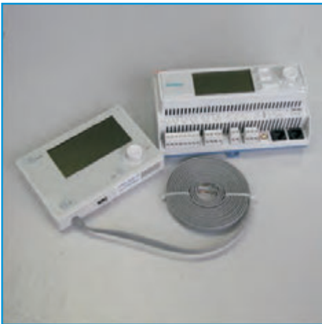
Контроллер Siemens – Climatix и панель оператора НМІ
